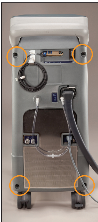
Fig. 8-10 Pannello posteriore con indicazione dei bulloni da rimuovere (Passaggio 2, a sinistra)
