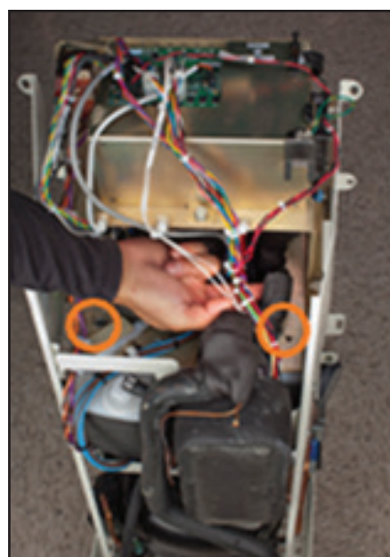
Fig. 8-17 Rimuovere due bulloni (Passaggio 2)
