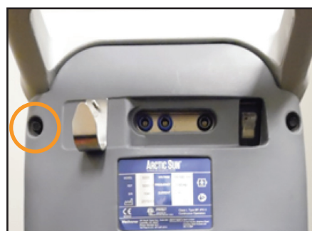
Fig. 8-72 Rimuovere i bulloni (Passaggio 1)
