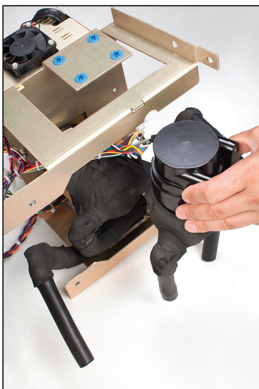
Fig. 8-31 Rimuovere con attenzione la pompa di miscelazione (Passaggio 5)
