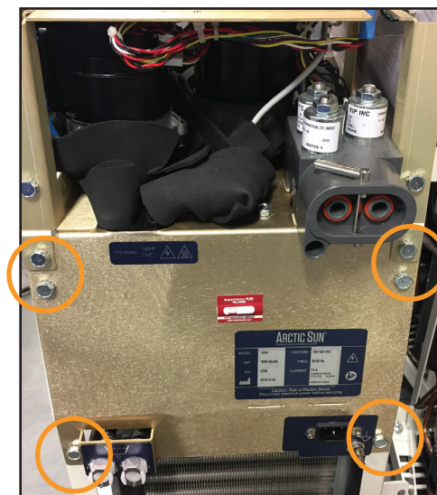
Fig. 8-36 Rimuovere sei bulloni (Passaggio 3)
