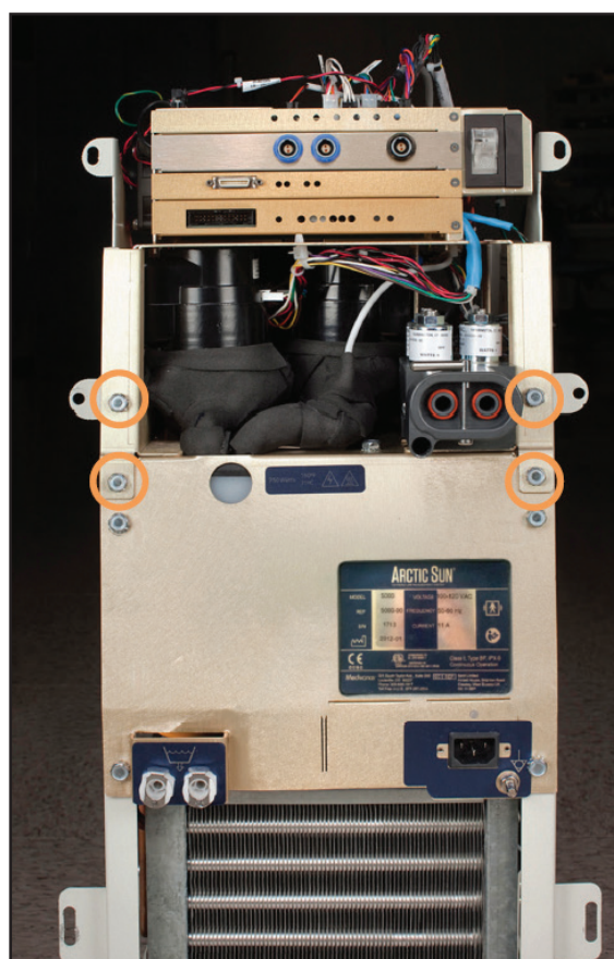
Fig. 8-16 Rimuovere quattro bulloni (Passaggio 1)
