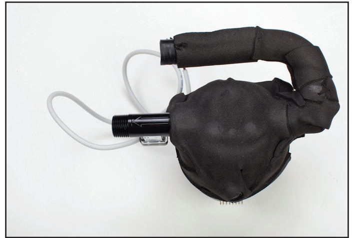
Fig. 8-53 Flussometro con freccia che indica la direzione del flusso; stessa direzione dell'uscita della pompa di circolazione
