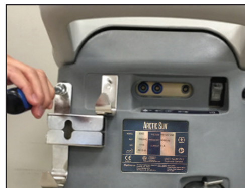
Fig. 8-73 Fissare la staffa (Passaggio 2)
